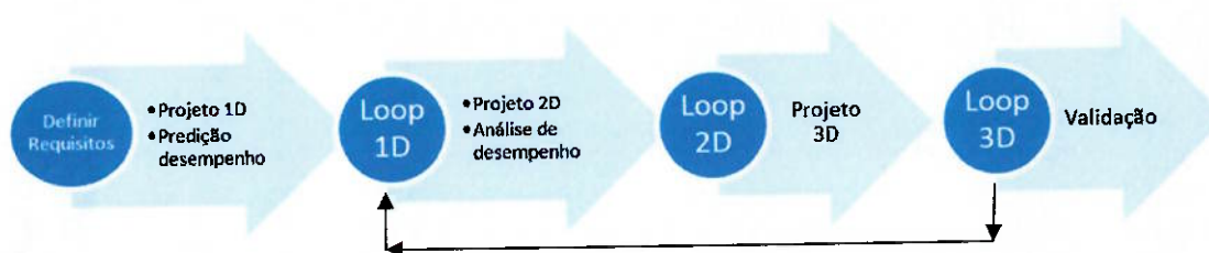
Figura 1 – Esquema do processo de projeto de compressores. As análises e predição de desempenho tornam-se mais complexas no decorrer do processo quando mais detalhes das geometrias propostas ao compressor são incluídos. A cada etapa há um loop , que representa a necessidade de testar diversas geometrias e reformular as entradas de acordo com as saídas já constatadas.
